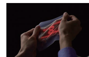
2018 東京大学と共同で、伸縮自在な薄型ディスプレイを開発：皮膚に貼れるスキンエレクトロニクス
